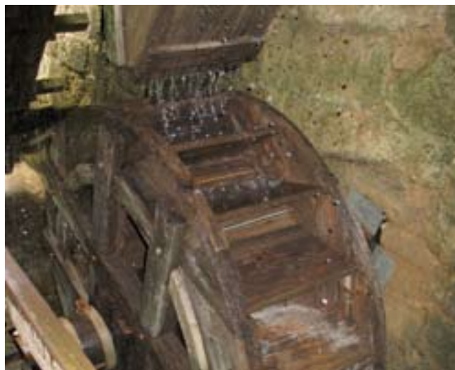
Mlińska kolo z rako, iz katere pada voda in poganja mlin.
