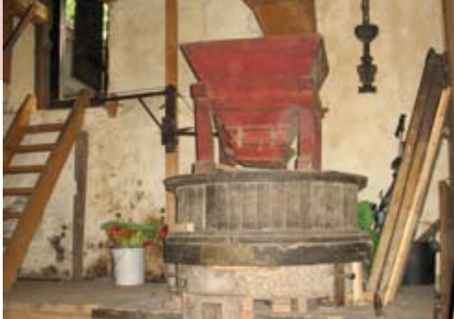
Še vedno delujoče in zelo stare stope za pridobivanje ješprenja in kaše z vidnim zazidanim vhomom.
